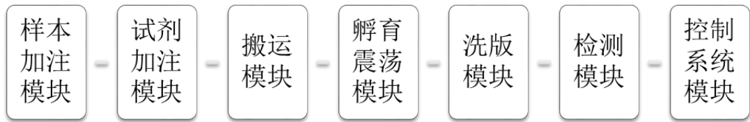
图 1 全自动时间分辨荧光免疫分析仪结构图
