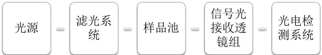
图 2 半自动时间分辨荧光免疫分析仪结构图
