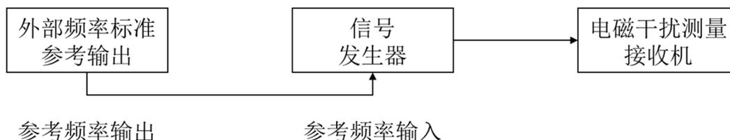
图 4 频率读数准确度的校准
