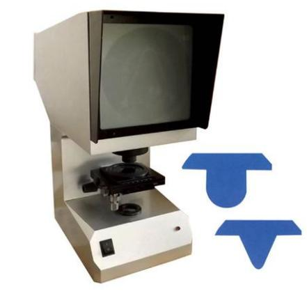
图 1 光学投影仪及检测规图
