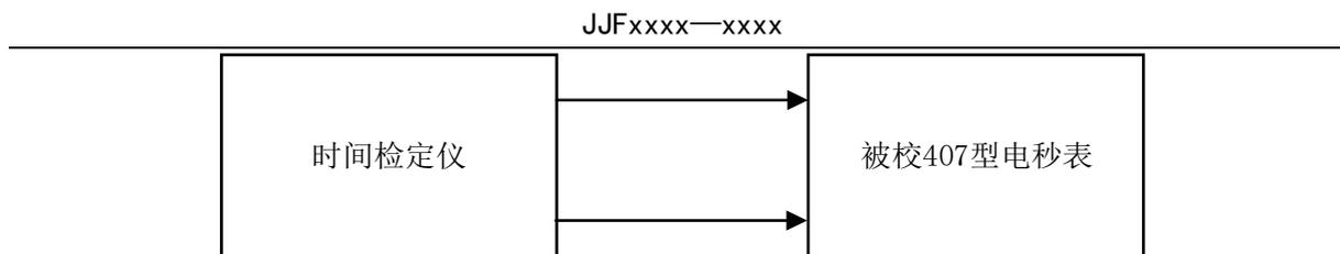
图3 407型指针式电秒表校准示意图
