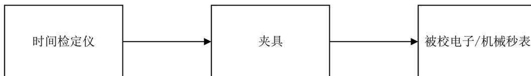
图1 电子/机械秒表校准示意图
