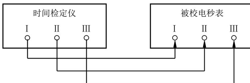
图2 电秒表校准示意图
