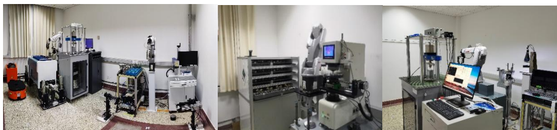
(a)洛氏无人值守系统 (b)布氏无人值守系统 (c)表面洛氏无人值守系统
