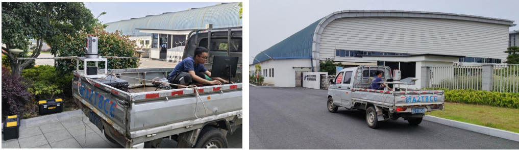
图 3-2 船载水陆一体化点云测距系统精标
