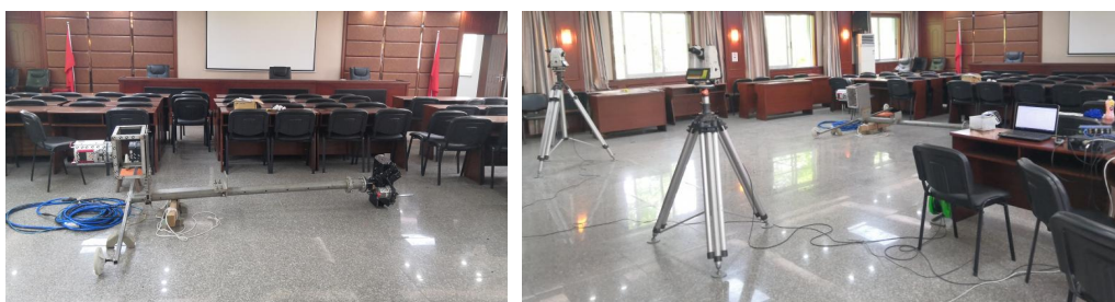
图 3-1 船载水陆一体化点云测距系统粗标
