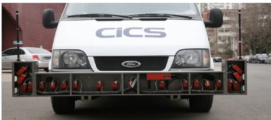
图 2 车载式路面磨耗快速检测仪
