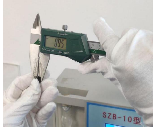
图 2 穿孔板厚度测量
