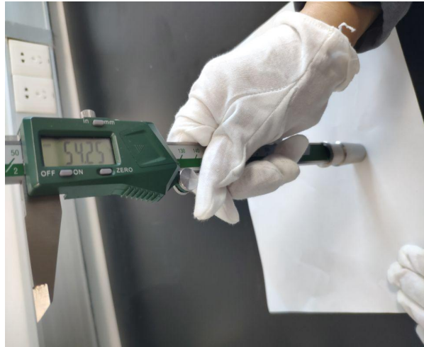
图 4 透气圆筒内底面至顶面的深度测量
