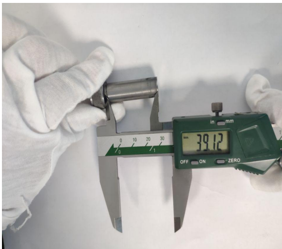
图 5 捣器底面至支持环下部的距离测量
