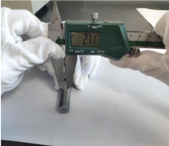
图 3 捣器扁平槽宽度测量
