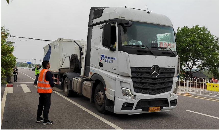
图2 高速弯沉仪距离测试现场试验图
