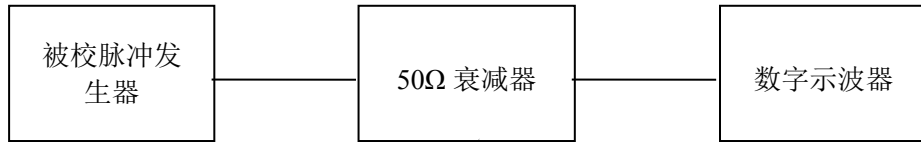
图9 试验脉冲 3a/3b 负载状态校准连接示意图
