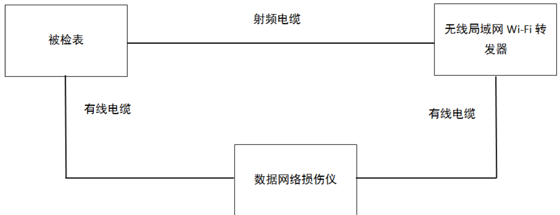
图 5 下行/上行丢包率测试连接图
