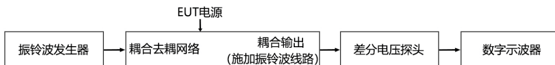
图 8 振铃波发生器接耦合去耦网络相移校准接线示意图
