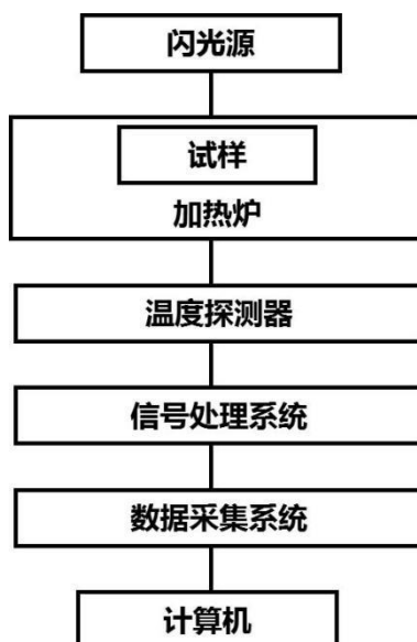
图 3 闪光法块体材料热扩散系数测量仪系统示意图
