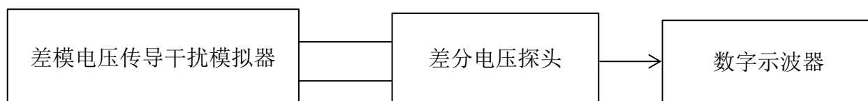
图 4 开路电压校准示意图
