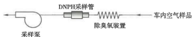
图2 DNPH（2,4-二硝基苯肼）采样系统的组成示意图
