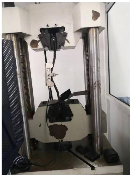
图 12 实验室条件下起重量限制器标定
