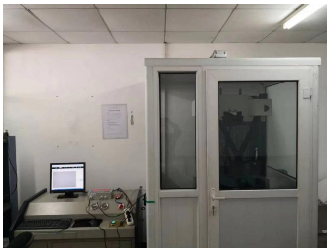
图 13 实验室条件下起重量限制器示值误差验证试验
