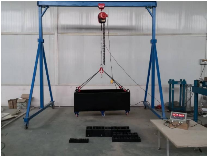
图 16 装机条件下起重量限制器示值误差验证试验
