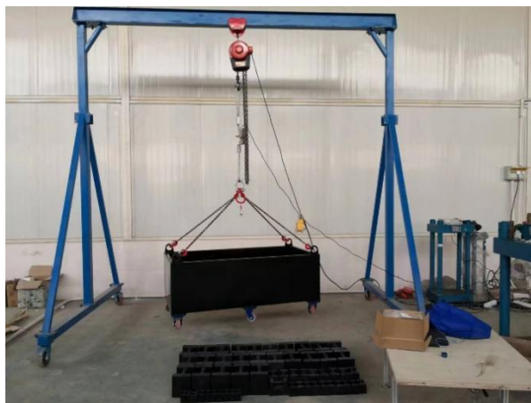
图 15 装机条件下起重量限制器标定
