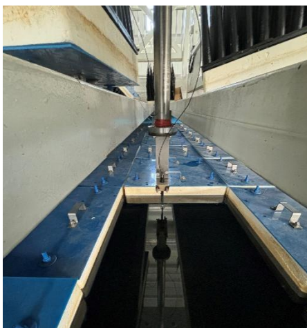
图 14 标准水听器安装
