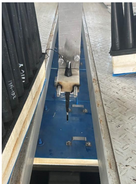
图 8 标准水听器安装
