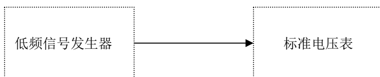
图 3 输出电压幅度校准连接示意图
