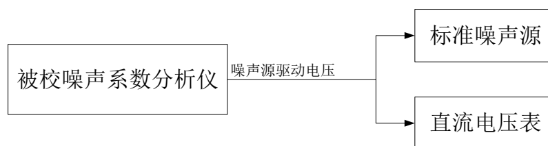
图 7 噪声源驱动电压校准框图
