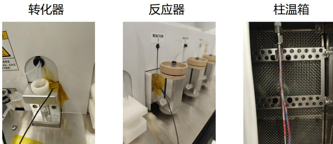
图 3 转化器、反应器、柱温箱的测温点
