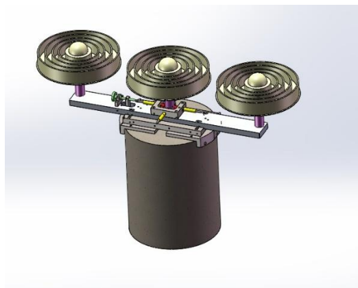
图2 GNSS接收机天线相位中心测试装置
