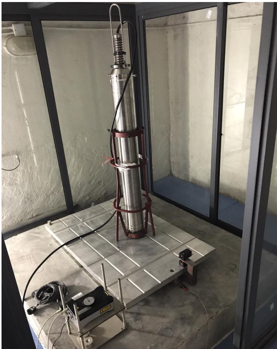
图1 井下垂直摆倾斜仪校准
