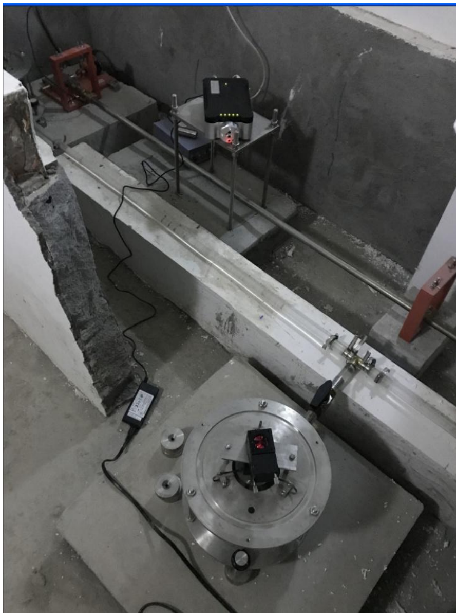
图1 DSQ型水管倾斜仪校准
