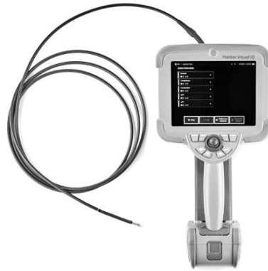
图 2 测量型工业内窥镜
