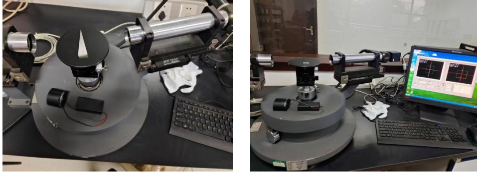
图4 以自准直仪示值为标准器读数的双准直光管照准测角仪
