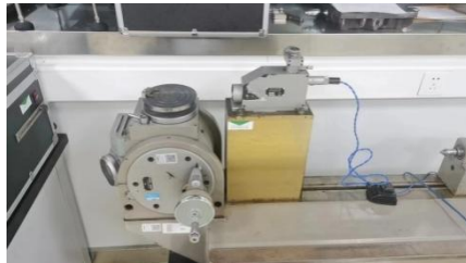
图 2 以高等级角度块为标准器的准直光管比较读数测角仪
