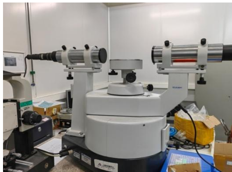
图 3 以度盘分度作为圆分度标准器读数的双准直光管照准测角仪
