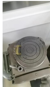
图 2 以高等级角度块为标准器的准直光管比较读数测角仪
