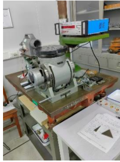
图 1 分度转台和自准直仪组合的测角仪
