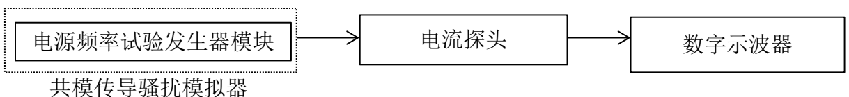
图 7 电源频率试验发生器模块源阻抗校准示意图
