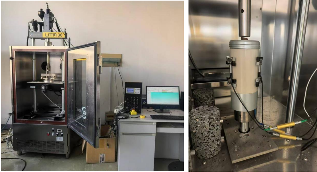
图 2 路面材料多功能试验机的实物图
