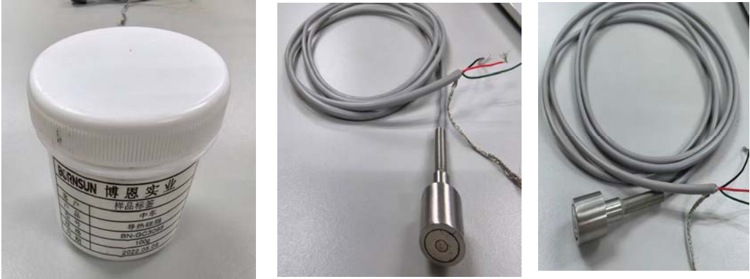
图 4 导热硅脂、磁吸式表面温度传感器
