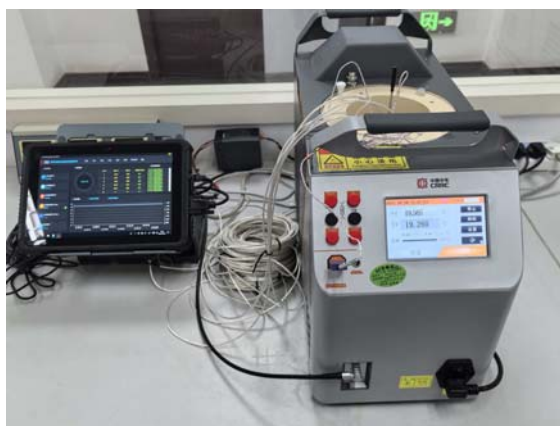
图 3 配置专用测试软件的恒温面源
